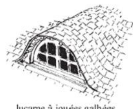
lucarne à jouées galbées (couverture ardoise ou chaume)
