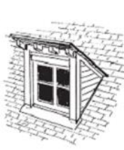
lucarne retroussée, ou demoiselle ; c'est aussi le vrai chien-assis
