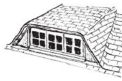
lucarne en trapèze ou rampante à jouées biaisées (couverture en bardeaux d'asphalte)
